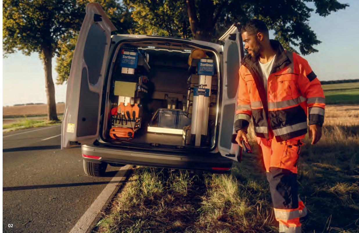
**01 Sortimo SR5 pre stranu vodiča.** Maximalizuje využitie ložného priestoru. Inteligentný regálový systém umožňuje perfektné prispôsobenie komponentov kontúram bočnej steny. Aj keď sú na oboch stranach vozidla nainštalované regály, vďaka štíhlym bočným profilom môžete aj nadalej umiestňovať europalety.
