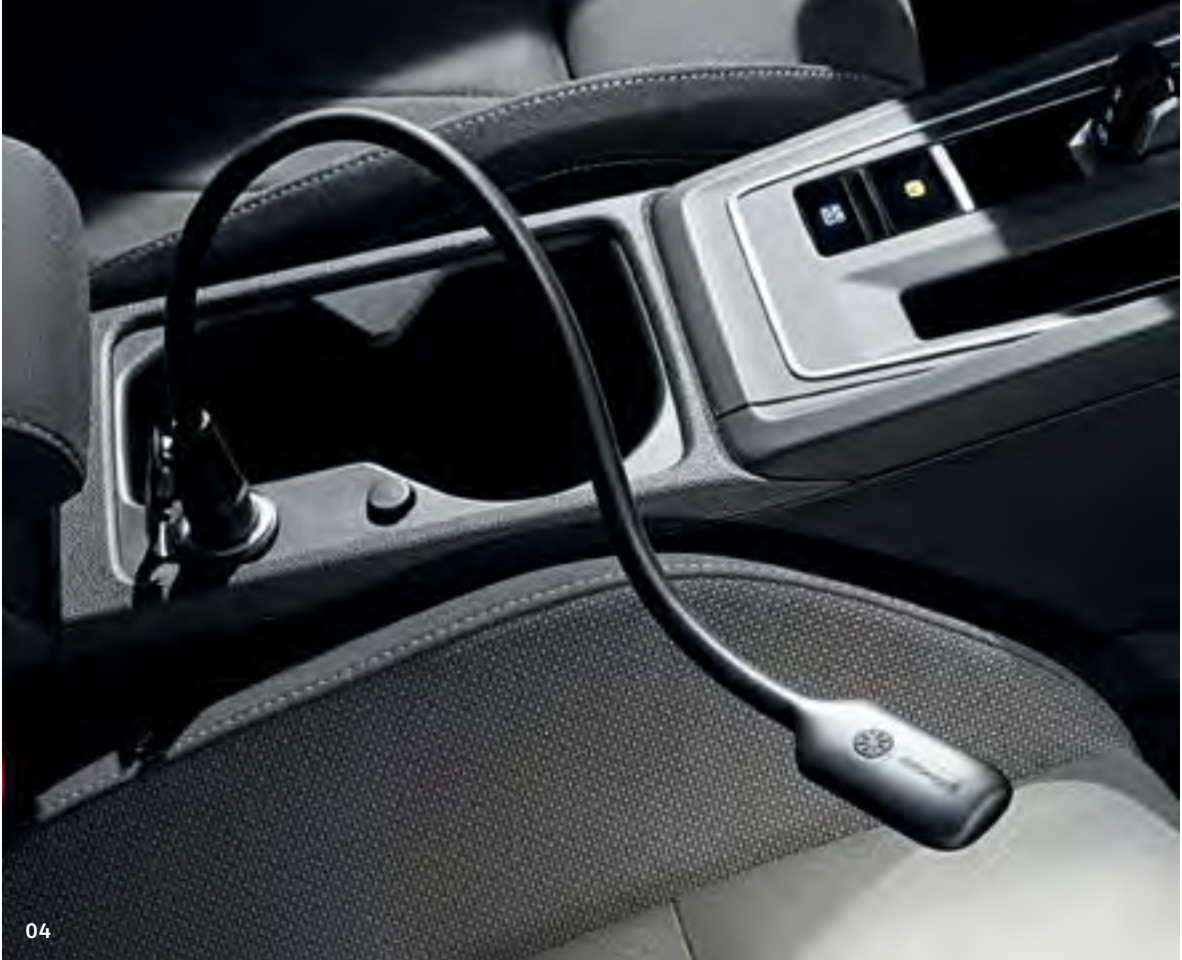
04-05 Energeticky úsporná Originálna LED lampička na čítanie Volkswagen (04) s nastaviteľným pružným krkom a logom Volkswagen umožňuje spolujazdcovi v noci čítať bez rušenia vodiča. Lampa sa zapája do zapalovača cigariet alebo zásuvky 12 V. Originálny tempomat Volkswagen 1 (05) po stlačení gombíka udržiava konštantnú rýchlosť vášho vozidla. Vďaka funkcii obmedzovača rýchlosti si okrem toho môžete nastaviť maximálnu rýchlosť, ktorú vaše vozidlo neprekročí, ani keď stlačíte pedál akcelérátora úplne na podlahu.
