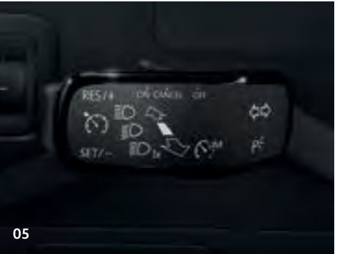
04-05 Energeticky úsporná Originálna LED lampička na čítanie Volkswagen (04) s nastaviteľným pružným krkom a logom Volkswagen umožňuje spolujazdcovi v noci čítať bez rušenia vodiča. Lampa sa zapája do zapalovača cigariet alebo zásuvky 12 V. Originálny tempomat Volkswagen 1 (05) po stlačení gombíka udržiava konštantnú rýchlosť vášho vozidla. Vďaka funkcii obmedzovača rýchlosti si okrem toho môžete nastaviť maximálnu rýchlosť, ktorú vaše vozidlo neprekročí, ani keď stlačíte pedál akcelérátora úplne na podlahu.
